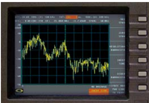
使用高速扫描功能可以方便的捕获反向通道侵入
