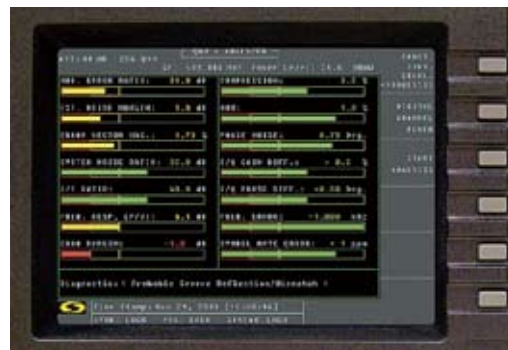
QAM的QIA显示屏幕 14项性能指标可以同时显示在一个屏幕上
